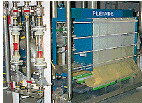
Le fluide à traiter circule en lames liquides minces entre les plaques qui sont agencées en séries et en parallèles. (*cf schéma ci-dessous*)
